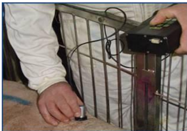
Fig. 2 Simultáneamente al pesaje se miden con ultrasonidos los grosores de tocino y lomo
